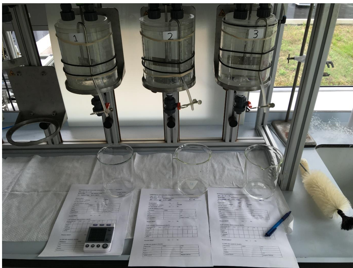
Figuur 1: Overzichtsfoto van het drietal bekerglazen welke gebruikt zijn tijdens de bezinkproeven
